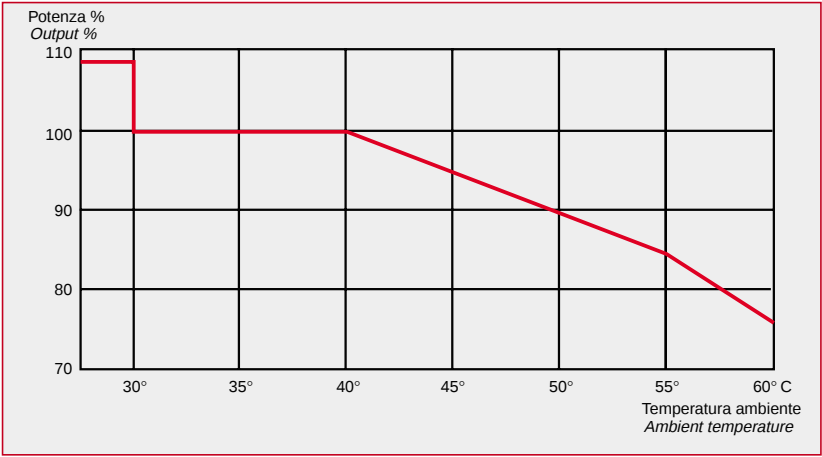
Fig. 1 Variazioni percentuali della potenza nominale in funzione della temperatura ambiente. Percentage variations of rated output as function of ambient temperature.
